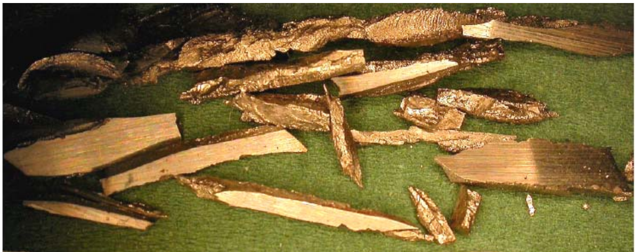
Figur 9: Samling af typiske afbrækkede og udfaldne splinter fra tandoverfladen.
