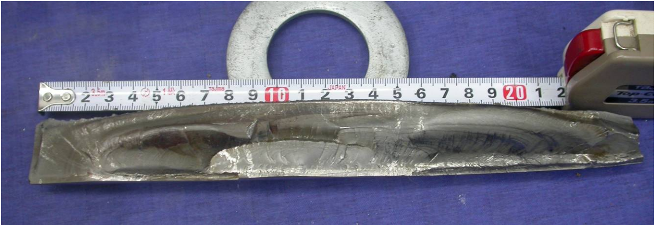
Figur 2: Foto af brudflade fra afbrækket tand. Typisk udseende for udmattelsesbrud.
